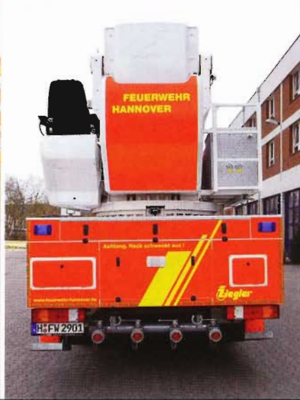
links: Die Abstützbreite beträgt bis zu sechs Meter. mitte: Heckansicht. Beim Ausfall der eingebauten Feuerlöschkreiselpumpe kann Löschwasser über vier B-Druckeingänge am Fahrzeugheck fremd eingespeist werden. rechts: Das Pumpenbedienfeld befindet sich ebenso wie der F-Saugeingang im Geräteraum G2.
