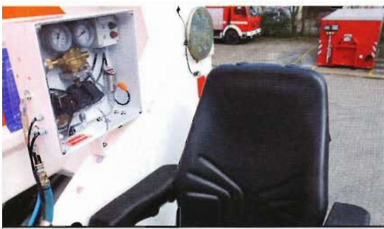
Am Hauptbedienstand befindet sich die Überwachungseinheit der »Air-Box 12 000«.
