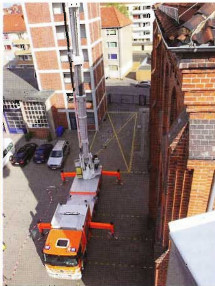
links: Die TMB 54 besteht aus einem fünfteiligem Mastaufbau mit einem einfach teleskopierbaren Korbarm. mitte: Aus 54 Metern Höhe ist die notwendige Abstützbreite von sechs Metern gut zu erkennen. rechts: Ein Hinterfahren von Gebäudeteilen ist möglich; die Steuerung erfolgt aus dem Korb.
