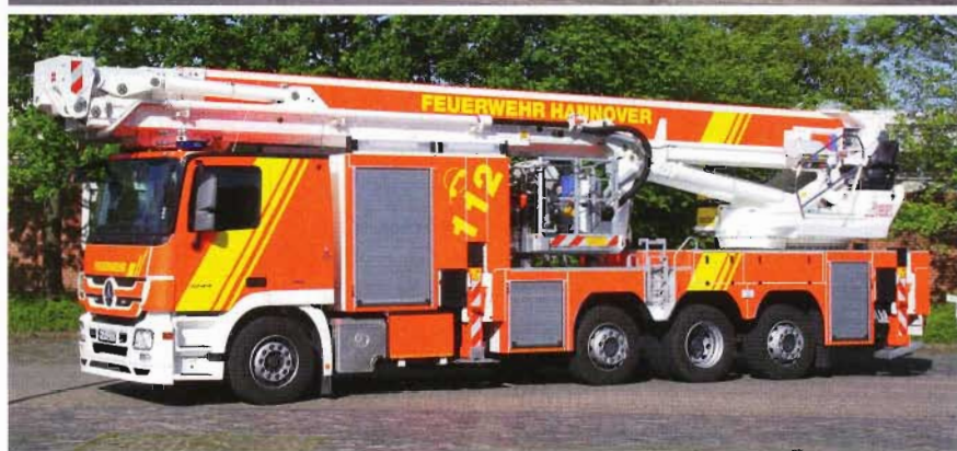
oben: Die Hubarbeitsbühne des Typs F 54 RLX wurde auf einem MB Actros 3244 aufgebaut. unten: Das Fahrzeug verfügt über eine Vorlauf- und eine Nachlaufkchse.
