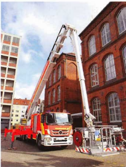
links: Die TMB 54 besteht aus einem fünfteiligem Mastaufbau mit einem einfach teleskopierbaren Korbarm. mitte: Aus 54 Metern Höhe ist die notwendige Abstützbreite von sechs Metern gut zu erkennen. rechts: Ein Hinterfahren von Gebäudeteilen ist möglich; die Steuerung erfolgt aus dem Korb.
