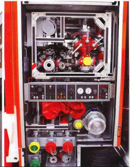
links: Die Abstützbreite beträgt bis zu sechs Meter. mitte: Heckansicht. Beim Ausfall der eingebauten Feuerlöschkreiselpumpe kann Löschwasser über vier B-Druckeingänge am Fahrzeugheck fremd eingespeist werden. rechts: Das Pumpenbedienfeld befindet sich ebenso wie der F-Saugeingang im Geräteraum G2.
