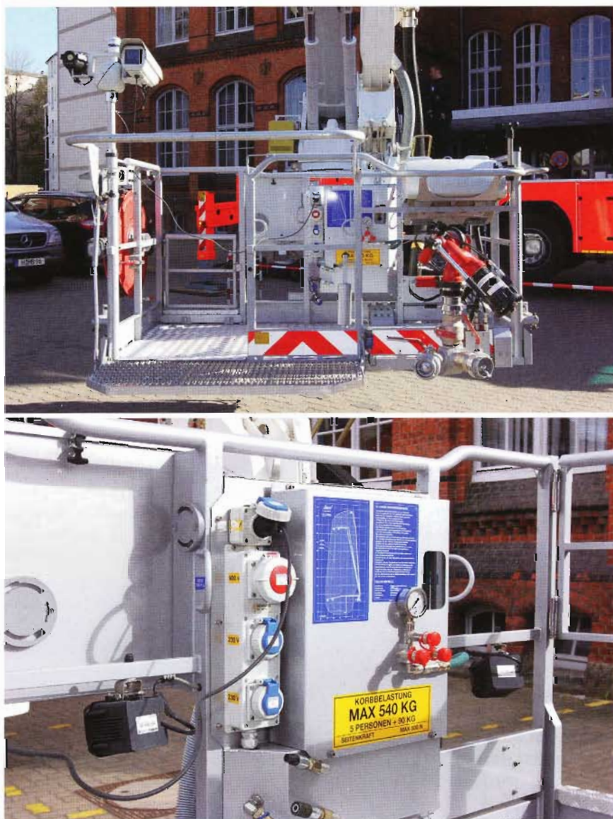
oben: Der 540-kg-Rettungskorb besitzt Aufnahmemöglichkeiten für Video- und Wärmebildkamera sowie für eine Wetterstation. unten: Im Korb befinden sich drei 230- und eine 400-Volt-Steckdose sowie Atemluftanschlüsse.
