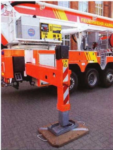
links: Die Abstützbreite beträgt bis zu sechs Meter. mitte: Heckansicht. Beim Ausfall der eingebauten Feuerlöschkreiselpumpe kann Löschwasser über vier B-Druckeingänge am Fahrzeugheck fremd eingespeist werden. rechts: Das Pumpenbedienfeld befindet sich ebenso wie der F-Saugeingang im Geräteraum G2.
